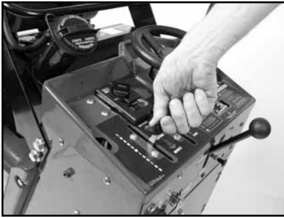
(D) Place Transmission Speed Lever in Neutral.
