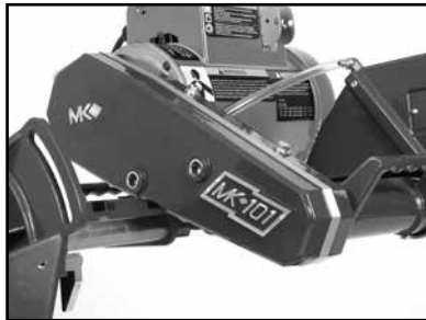
(D) Install the Cutting Head onto the front pivot hole
