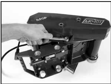
(D) Remove Belt Guard bottom bolt
